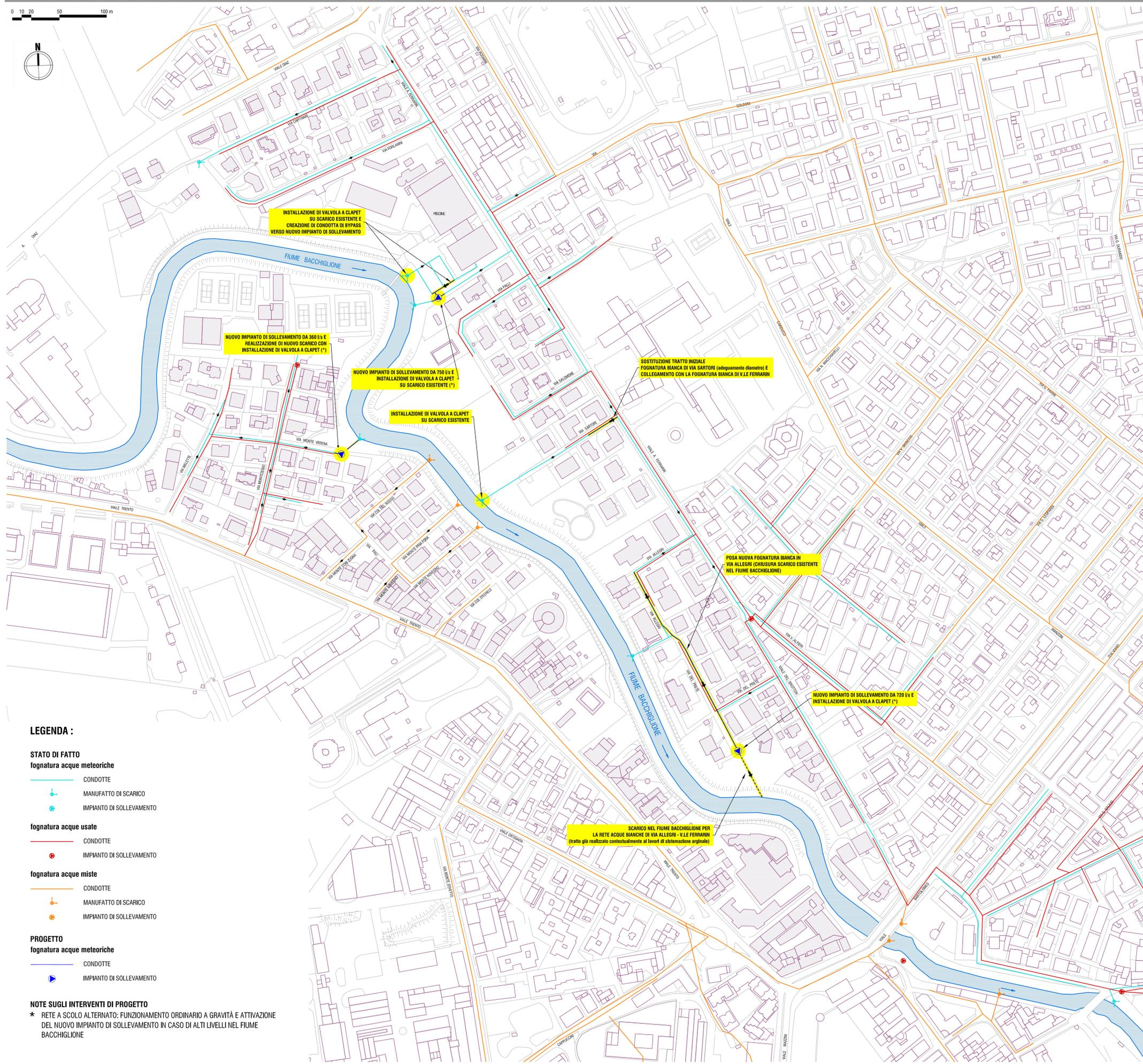
INSTALLAZIONE DI VALVOLA A CLAPET SU SCARICO ESISTENTE E CREAZIONE DI CONDOTTA DI BYPASS VERSO NUOVO IMPIANTO DI SOLLEVAMENTO
