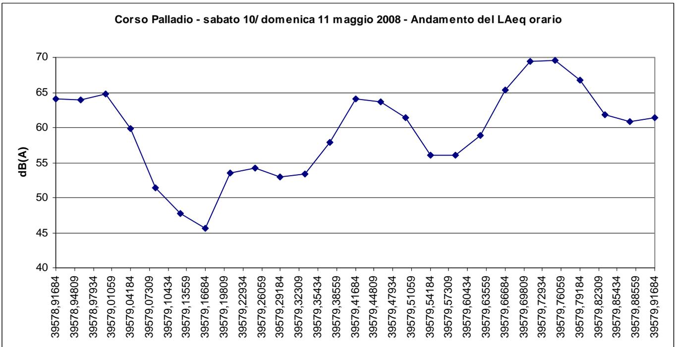
**Grafico 8: andamento orario del LAeq di un giorno rappresentativo per il secondo punto di misura; sono state scelte le 24 ore fra sabato e domenica per valutare il rumore in un periodo di chiusura del cantiere prospiciente**
