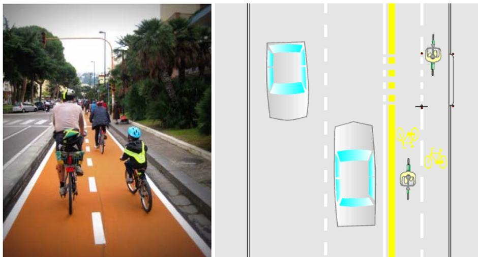
Figura 7: Immagine e schema di una pista ciclabile
