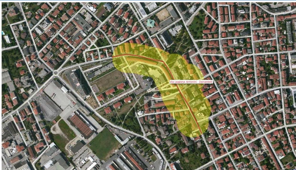
In giallo l'area critica, in rosso i tratti in cui è ritenuta tecnicamente realizzabile l'installazione di asfalto fonoassorbente
