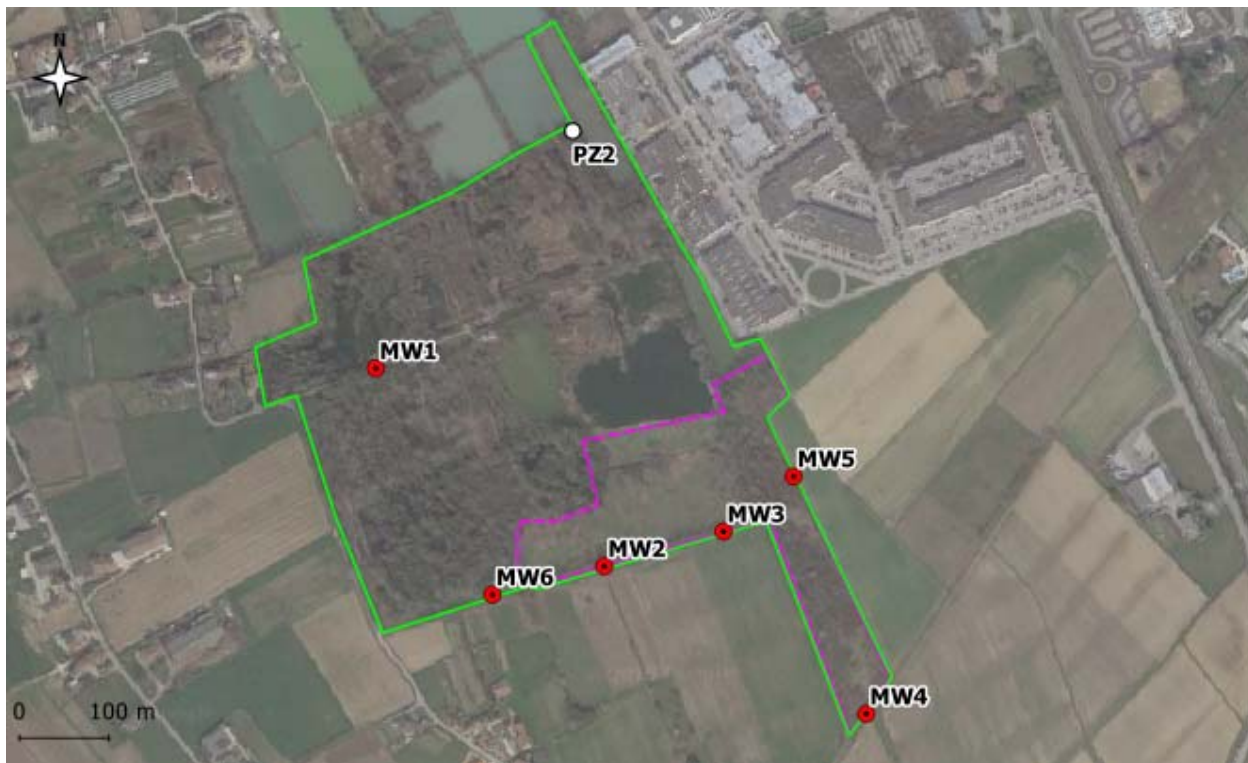
Figura 10 – Ubicazione dei piezometri di controllo, pregressi (marcatore bianco) e di prevista futura realizzazione (marcatore rosso)
