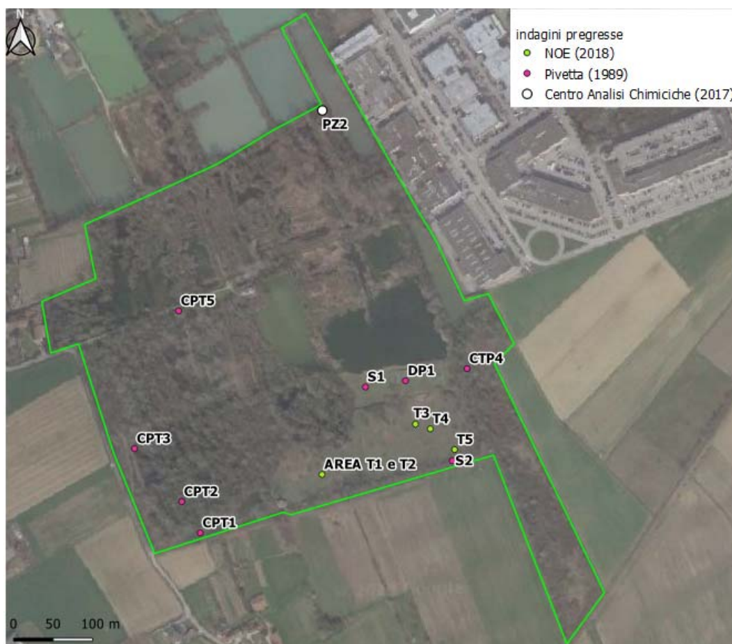
Figura 7 – Ubicazione indagini pregresse del sottosuolo all'interno dell'Oasi (DP = prova penetrometrica dinamica; CTP = prova penetrometrica statica; S = sondaggio; T = trincea)
