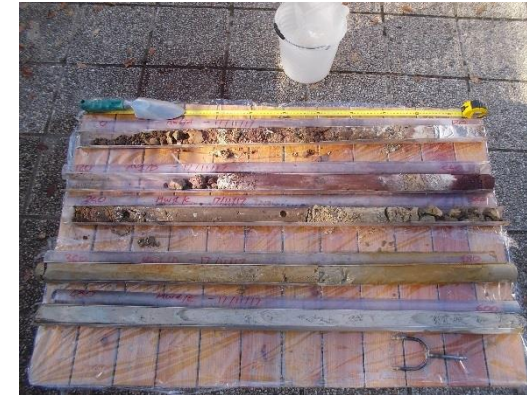
Sondaggio MW1 – carote 0.0-6.0 m
