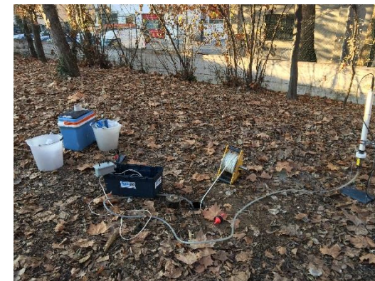
Spurgo del piezometro MW2
