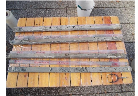
Sondaggio MW1 – carote 6.0-10.8 m
