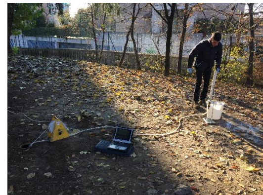
Spurgo del piezometro MW1
