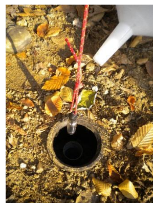
Posizionamento sonda di livello in piezometro per la registrazione dei dati dello slug-test
